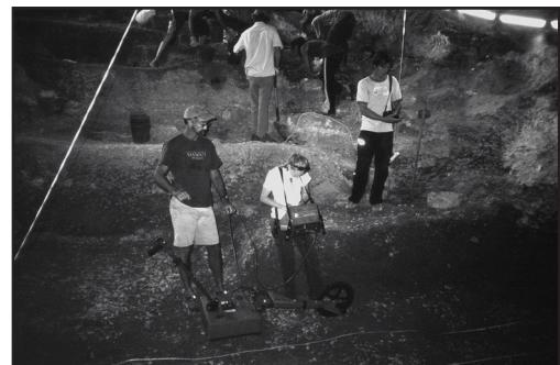
Obrázek 5. Aplikace GPR na lokalitě s cílem identifikovat hloubku skalního podloží. Zleva L. Conyers a K. Elliott.
